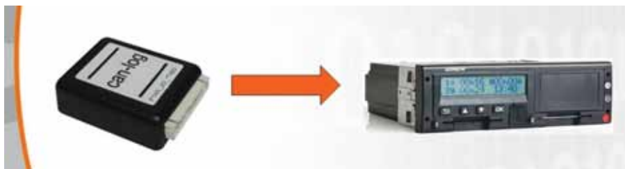
В тахограф встраивается CAN-адаптер
