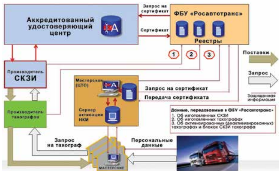
Схема информационного обмена при активации блока СКЗИ тахографа
