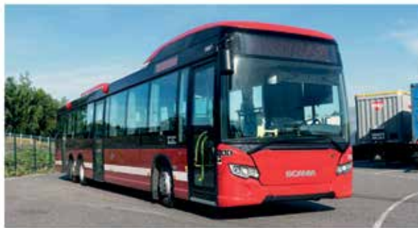
Полунизкопольное исполнение 12 м, 14,8 м Класс 1 и класс 2 Евро-4 дизель и В100 биодизель Срок текущей окупаемости: 4-7 лет
