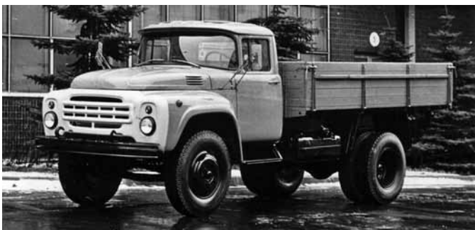
ЗИЛ-130-76 отличался иным расположением головной светотехники и рисунком облицовки радиатора
