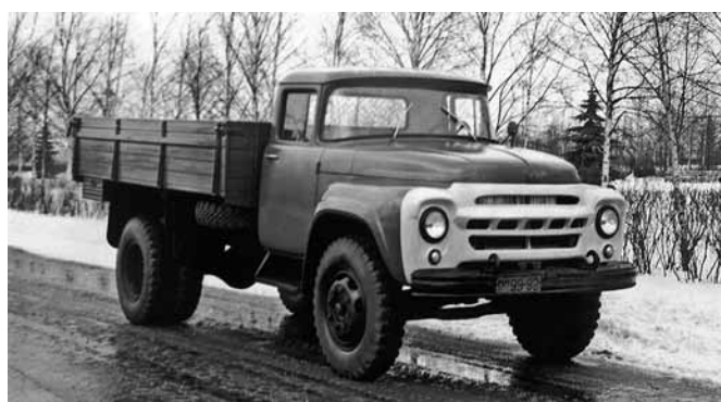
Вариант ЗИЛ-130 1960 года с двигателем ЗИЛ-130 и облицовкой радиатора, близкой к серийной модели
