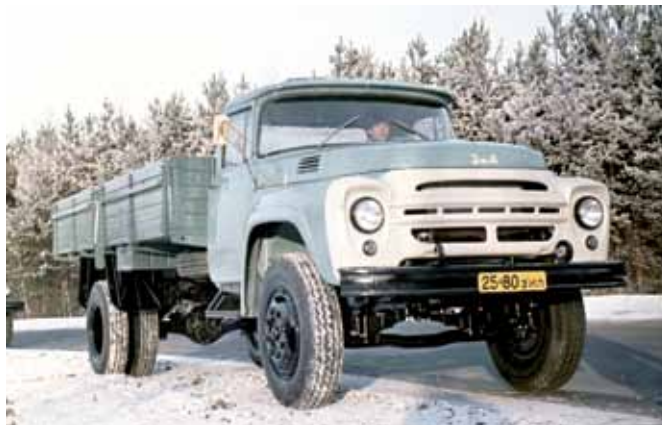
ЗИЛ-130Г с удлиненной до 4,5 м колесной базой
