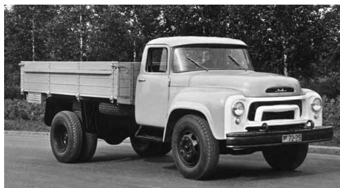
Опытный ЗИЛ-130 1957 года с измененным оперением и двигателем ЗИЛ-120 ВК
