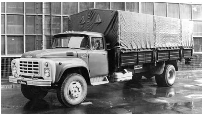
Опытный ЗИЛ-130ГУ с особо длинной базой и измененной решеткой радиатора
