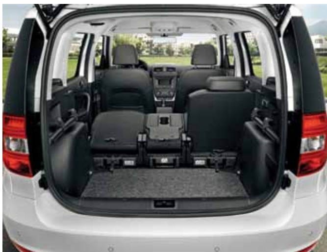
Благодаря системе трансформации салона VarioFlex объем багажника может быть увеличен с 322 до 1665 л
