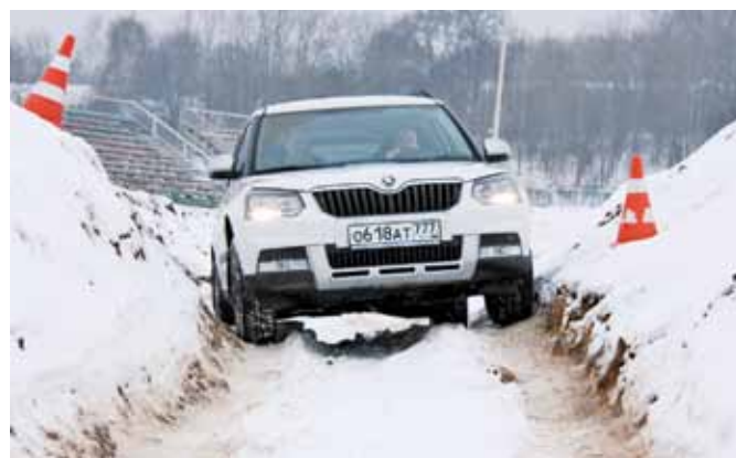
Клиренс Skoda Yeti составляет 180 мм, угол въезда – 19°, угол съезда – 32°
