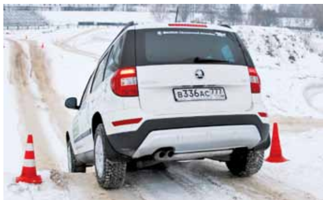
Система помощи при спуске поддерживает постоянную скорость без участия человека
