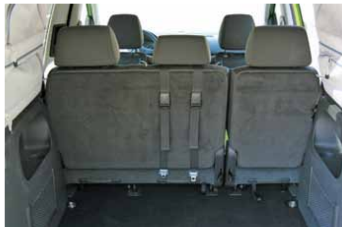
Салон имеет широкие возможности трансформации для размещения различного груза. При откинутых креслах заднего ряда высвобождается более 3 кубических метров полезного пространства для грузов
