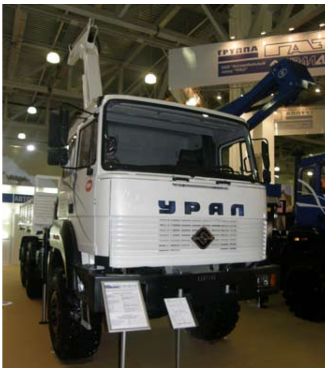
Бортовой Урал-4320-3171-78 с краново-манипуляторной установкой
