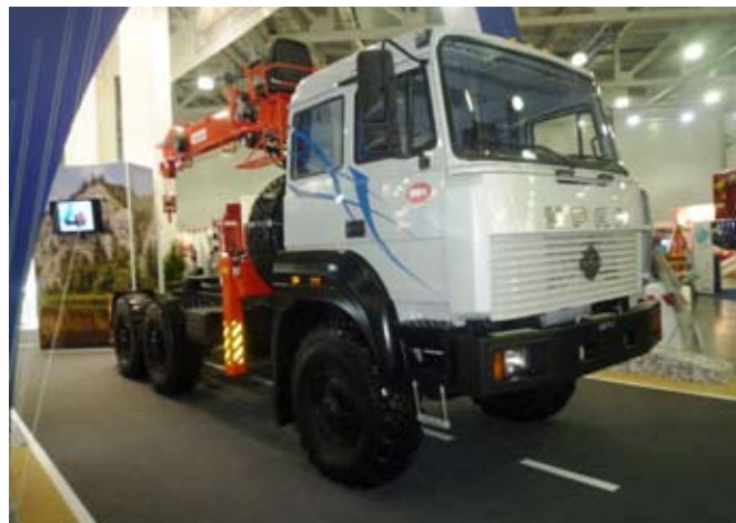
Седельный тягач Урал-44202-3511-80 с краном-манипулятором
