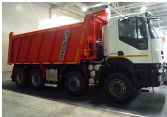
Самосвал IVECO-AMT-753901 с колесной формулой 8x4
