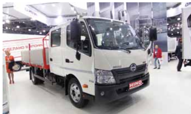
Автомобиль Hino серии 300 полной массой 7,5 т с двухрядной кабиной с бортовой платформой
