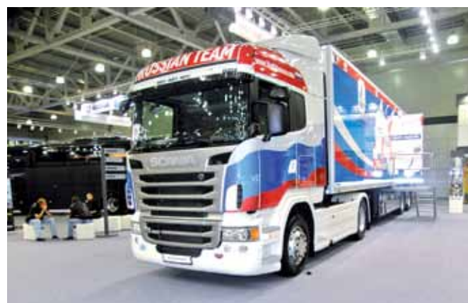
Тягач Scania R420 со специальным полуприцепом для смазки лыж для российской сборной по биатлону
