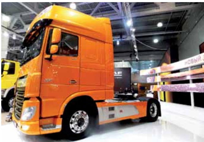
Тягач DAF FT XF510 4x2 Евро-6 с кабиной Super Space Cab
