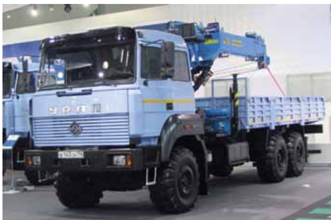
Урал-4320-4971-80 с краноманипуляторной установкой
