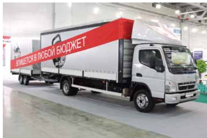
Автопоезд Mitsubishi Fuso Canter с тентовой бортовой платформой и тентовым прицепом
