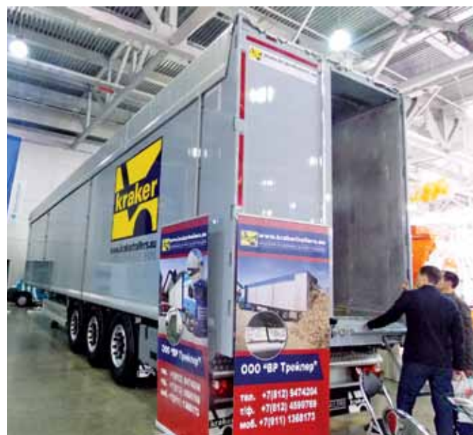
Полуприцеп с гидравлической системой подвижного пола CF-Best Kraker
