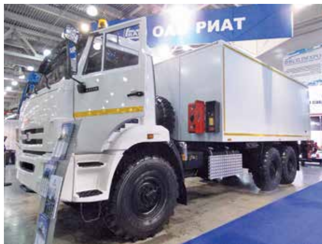
Автомобиль для перевозки и временного хранения взрывчатых материалов и веществ и опасных грузов
