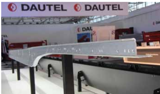
Эти лонжероны изготовлены методом холодного проката
