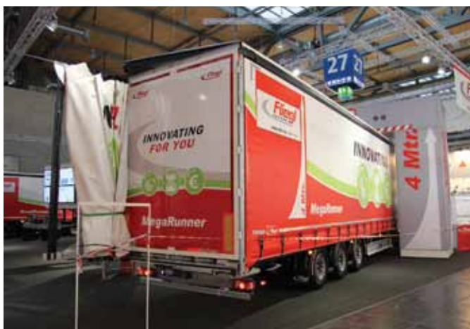
Fiegl Mega Runner: при габаритной высоте 4 м высота грузового пространства достигает 3 м
