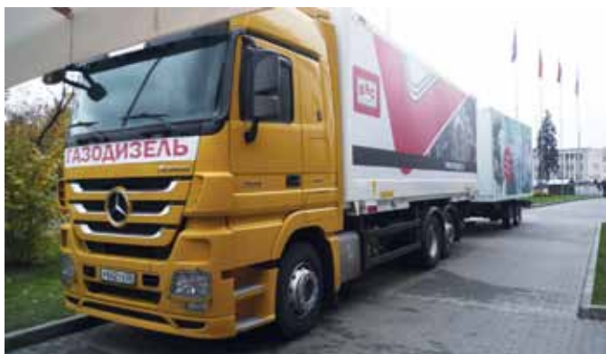
Газодизельный Mercedes-Benz Actros с электронной системой впрыска фирмы BRC
