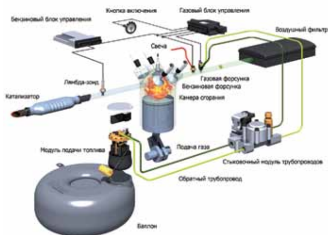
Схема ГБО пятого поколения LiquidSI и LiquidDI компании «Vialle»
