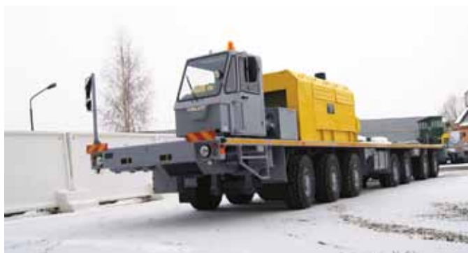
Семиосное шасси МЗКТ-800500-011 под установку спецоборудования
