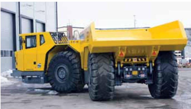
Благодаря шарнирно-сочлененной раме MT42 обладает хорошей маневренностью
