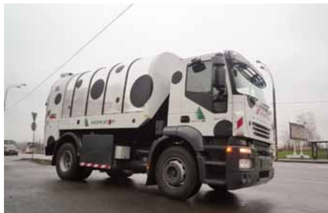
Мусоровоз роторного типа Kaoussis CRV 1600
