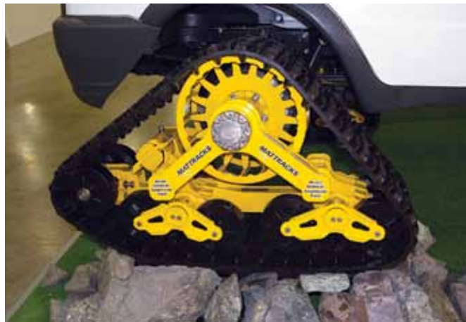
Главная изюминка «Соболя» – гусеничные движители 105M1-A1 Suspension track
