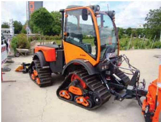
При необходимости Holder S 990 оснащают резиновыми гусеницами
