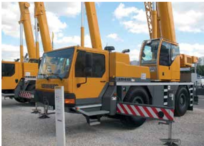
Кран LTM 1030-2.1, оборудованный системой регулировки опорной базы VarioBase
