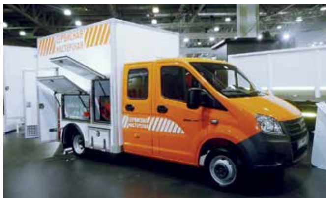
Ремонтная «летучка» на шасси «ГАЗель NEXT»
