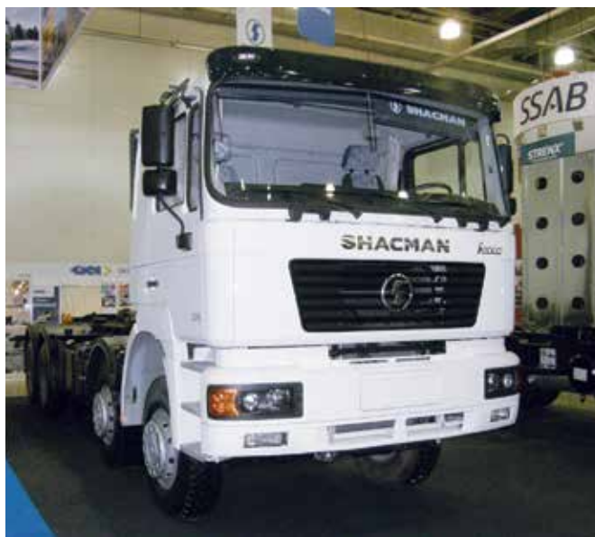
Shacman SX3316 с устройством самопогрузки типа мультилифт
