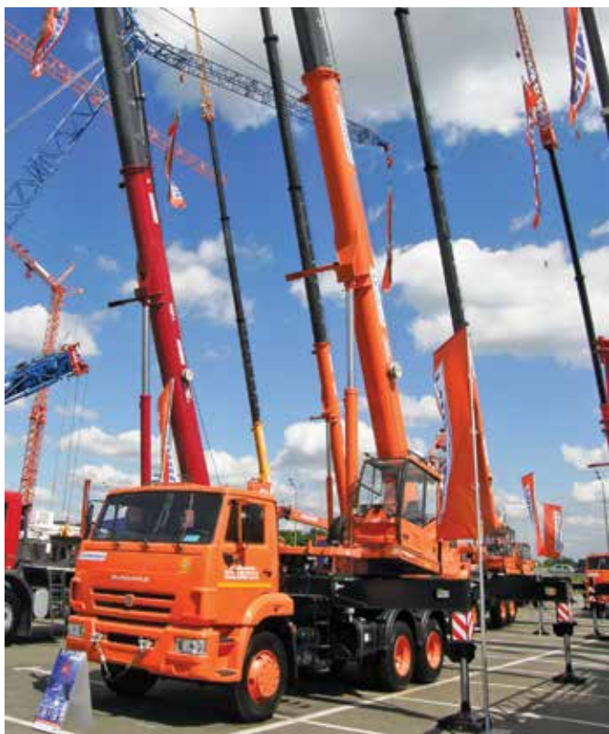
Автокран КС-55713-1К-4В грузоподъемностью 25 т на шасси КАМАЗ-65115 (6x4)
