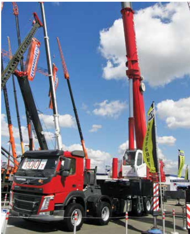
Автомобильный кран КС-85713 «Галичанин» грузоподъемностью 100 т
