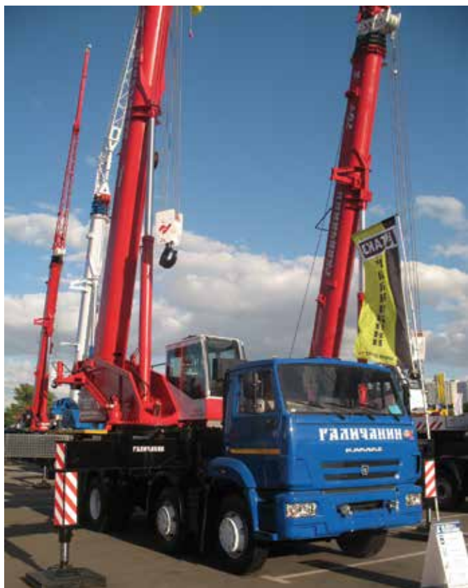
25-тонный кран КС-55731-1 на шасси КАМАЗ-6540 (8х4)
