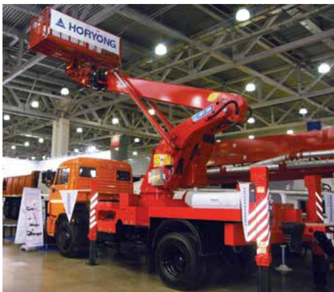
Подъемник Horyong Sky 280S на базе КАМАЗ-43253
