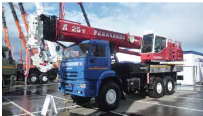
Модель КС-55731-4 на базе КАМАЗ-65222 (6х6)
