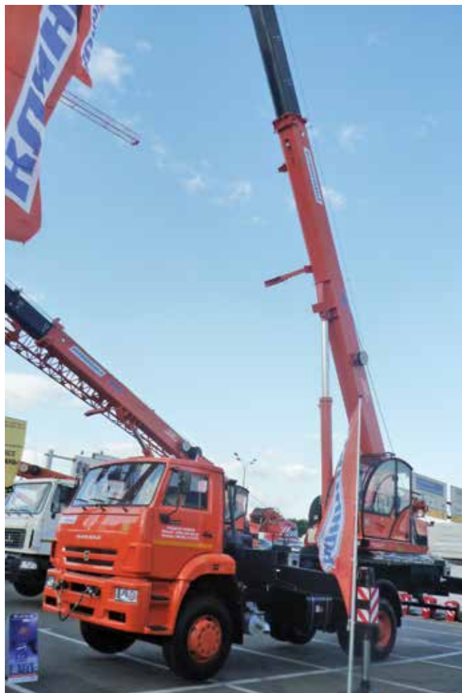
16-тонный автокран КС-45719-8К «Клинцы» на шасси КАМАЗ-43253 (4x2)
