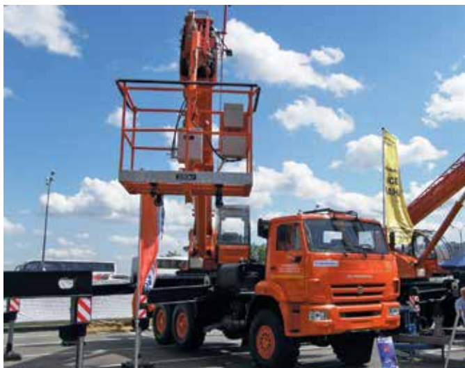
Кран-подъемник ПКС-55713-5К-3 на шасси КАМАЗ-65115 (6x4), КАМАЗ-43118 (6x6)
