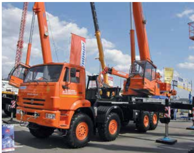
Модель КС-65719-3К грузоподъемностью 40 т на шасси КАМАЗ-63501 (8x8)
