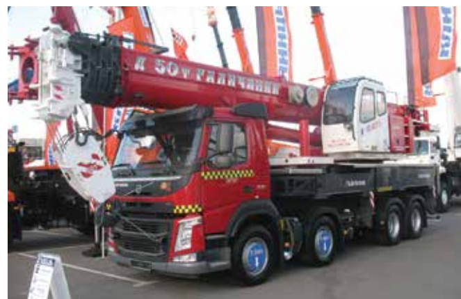
Автомобильный кран КС-65715 грузоподъемностью 50 т на шасси Volvo FM 330 (8х4)
