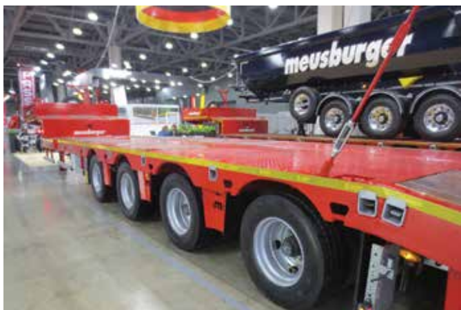
Четырехосный трал Meusburger Новтрак позволяет перевозить до 58 тонн при собственном весе в 14 тонн
