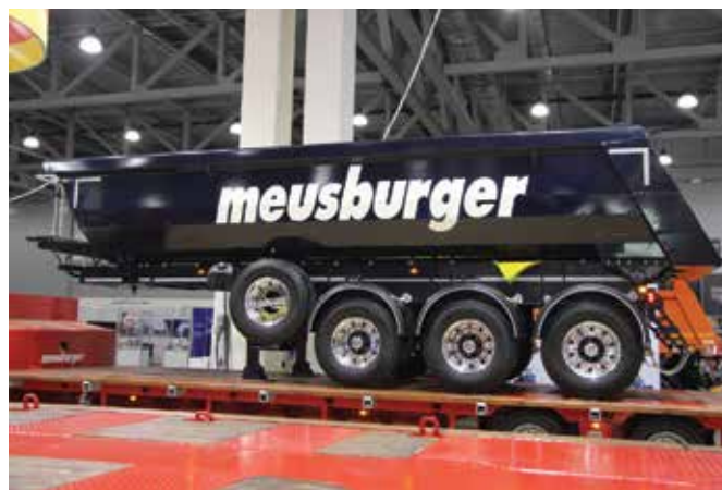
Самосвальный полуприцеп Meusburger Новтрак вмещает 22 м 3 нерудных материалов
