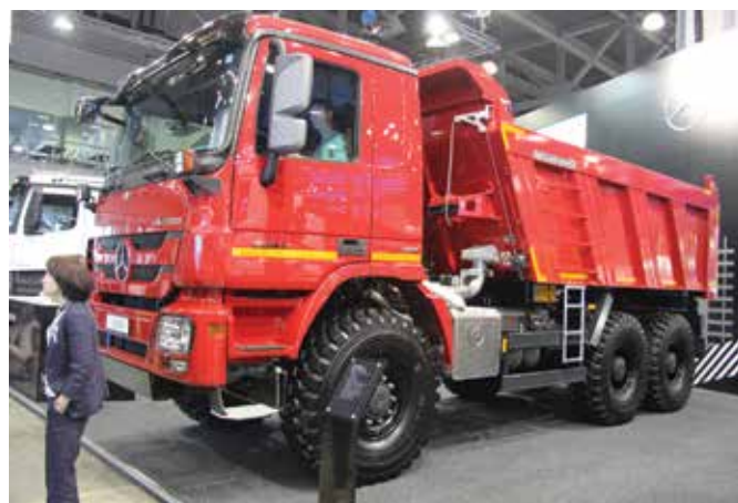
Полноприводный Actros 3341 АК с односкатной ошиновкой может эксплуатироваться в условиях тяжелого бездорожья
