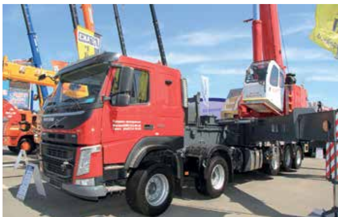
Автокран КС-65715 TAXI грузоподъемностью 50 тонн производства ГАЗ
