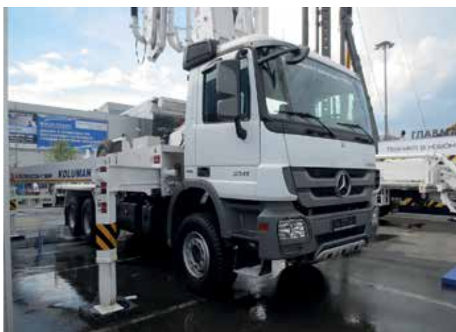
Koluman JXZ 38-4.16HP JUNJIN – первый, построенный в России, автобетононасос на 3-осном шасси Mercedes-Benz Actros 3341
