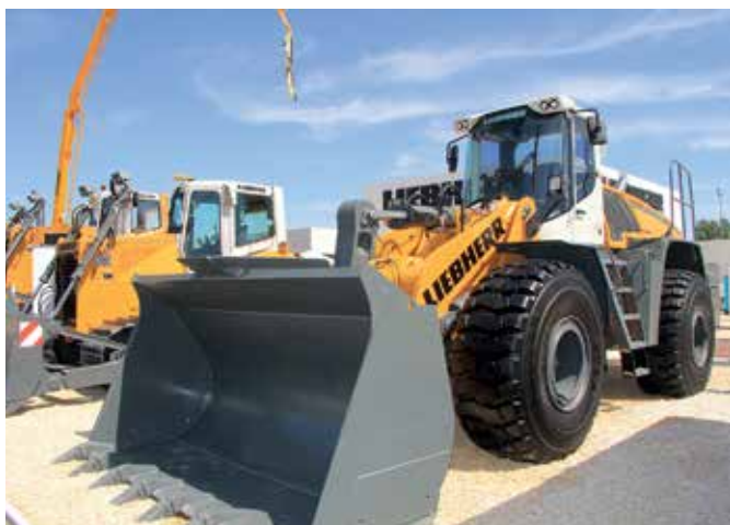
Колесный погрузчик Liebherr L 566, оснащенный землеройным ковшом объемом 4,0 м 3
