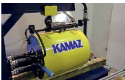
Многошпиндельный гайковерт с электронным управлением по моменту затяжки – продукт диверсификации ПАО «КАМАЗ»
