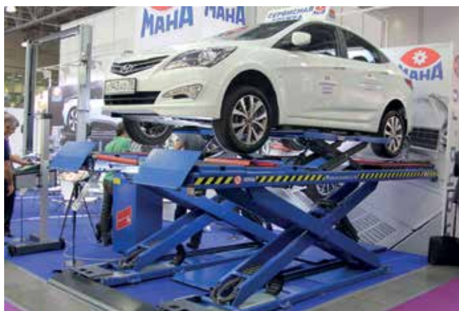
Ножничный подъемник MAHA DUO CM предназначен для использования на посту регулировки сход/развала
