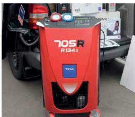
Станция для проверки кондиционеров TEXA Konfort серии 705R
