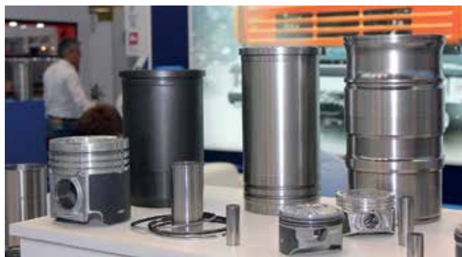
Современная технология «сырой» гильзы, внедренная на Камском моторном заводе, позволяет выпускать гильзы цилиндров из специального чугуна
