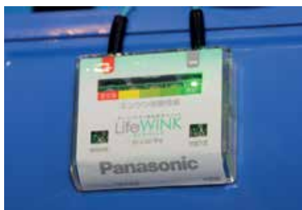
Устройство Panasonic Life WINK отслеживает степень заряда аккумулятора и бортовое напряжение сети
