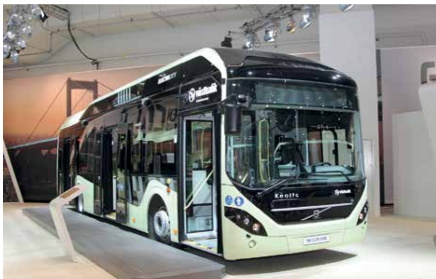
Volvo 7900 Electric Hybrid оснащен 240-сильным дизелем и электромотором
