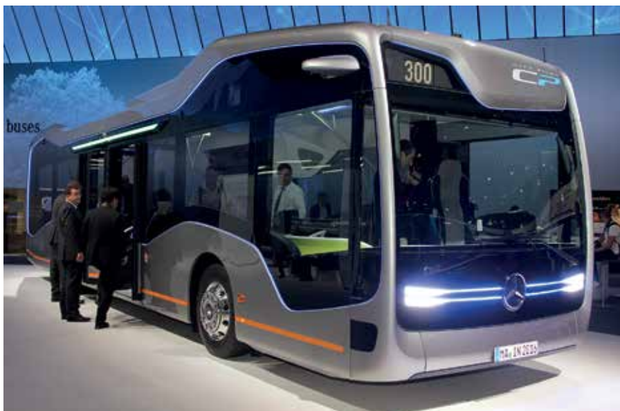
Автобус-беспилотник Future Bus, базирующийся на модели Mercedes-Benz Citaro, оснащен автономной системой City Pilot с набором радаров и датчиков
