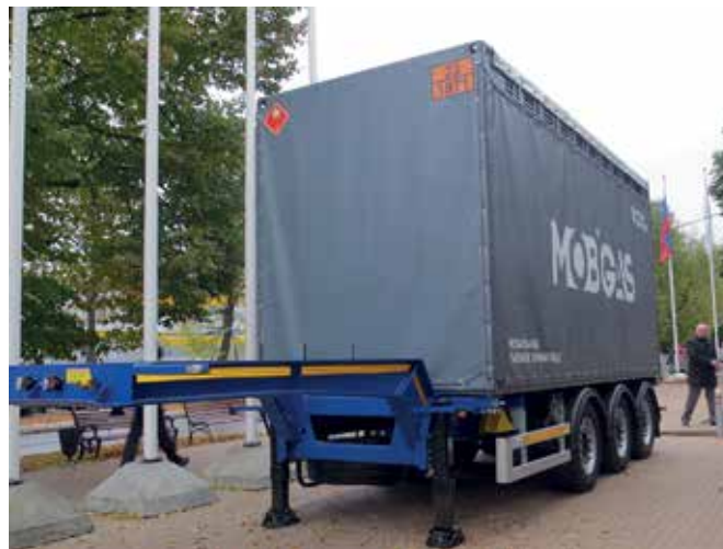
Мобильное газовое хранилище Mobigas от компании «Русские цилиндры»
