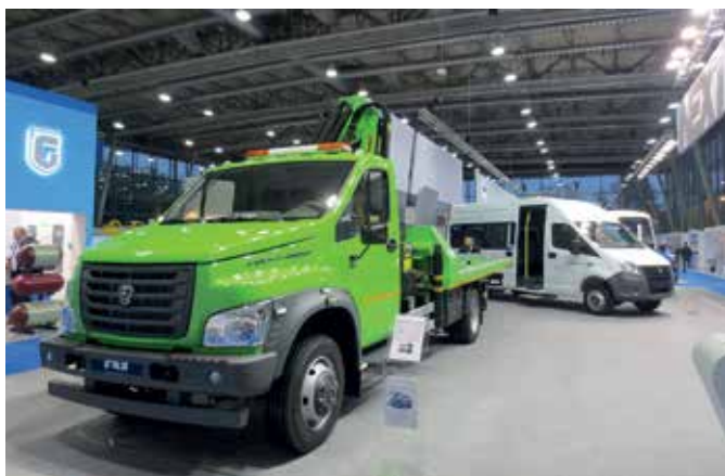
Эвакуатор на базе «ГАЗон NEXT CNG» оснащен газовым двигателем ЯМЗ-534 CNG
