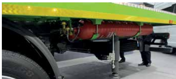
Семь газовых баллонов объемом 72,8 м 3 обеспечивают запас хода не менее 370 км
