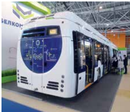
Электрооборудование размещено в заднем отсеке, под боковыми люками в верхней части салона и на крыше в герметичном корпусе
