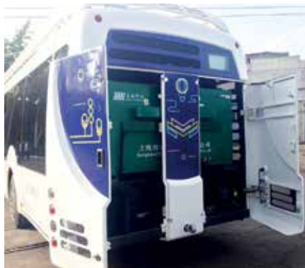
Электрооборудование размещено в заднем отсеке, под боковыми люками в верхней части салона и на крыше в герметичном корпусе
