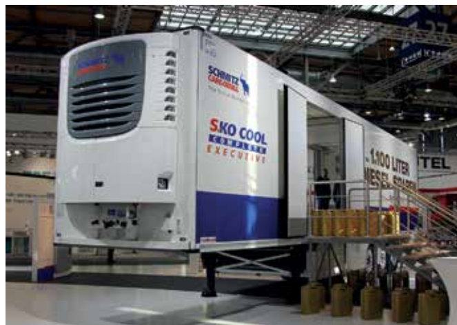
Благодаря улучшенной термоизоляции Schmitz S.KO Cool Complete его энергопотребление снизилось на 15%
