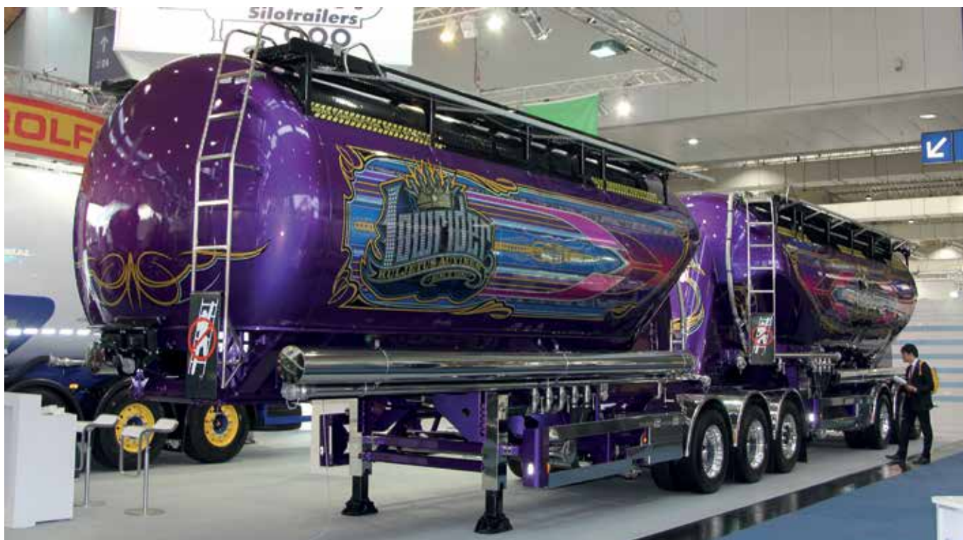
Двухзвенный цементовоз O.ME.P.S суммарной вместимостью 72 м³
