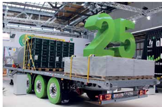
Решения по системам безопасного крепления груза на примере полуприцепа Fliegl Greenlight Coil
