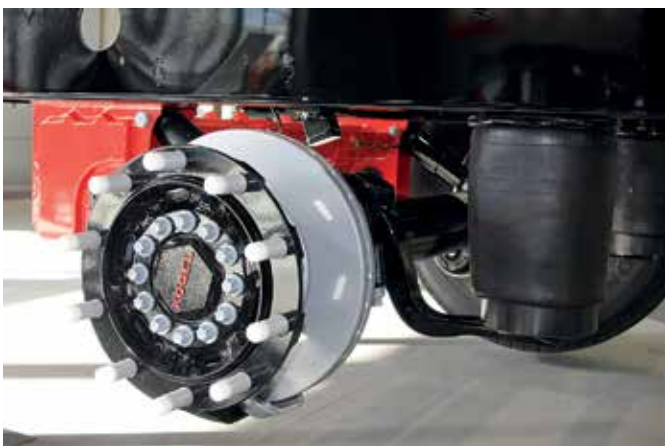
Серийный вариант оси KTA, в отличие от прототипа, получил ряд доработок, направленных на упрощение обслуживания
