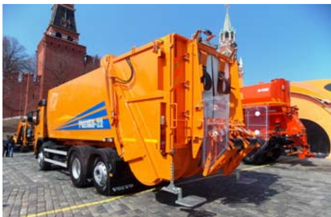
Мусоровоз Kobit Presco-22 на шасси Volvo FM 330
