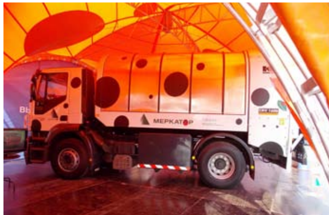
Газовый мусоровоз роторного типа Kaoussis CRV 1600
