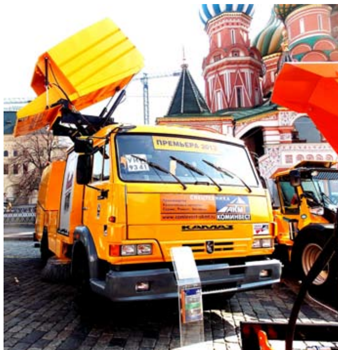
Подметально-уборочная машина Brodd Spider на шасси КАМАЗ-4308
