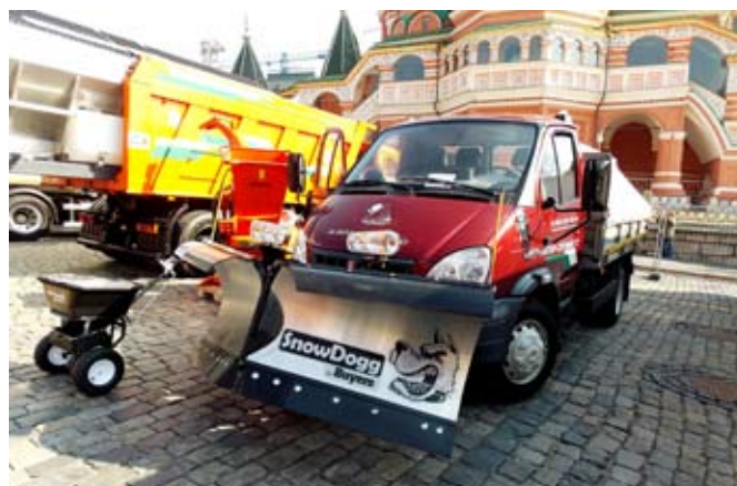
Коммунальная дорожная машина на шасси ГАЗ-33106 «Валдай» с распределителем реагентов SaltDog
