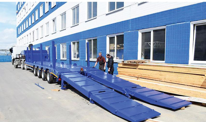
«Уральский завод спецтехники» выпустил новый полуприцеп – низкорамный четырехосный тяжеловоз с гидротрапами.
