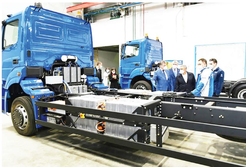
Специалисты Научно-технического центра ПАО «КАМАЗ» работают над созданием электрических грузовых автомобилей, первым из которых стал электрический мусоровоз с индексом 53198 – КАМАЗ-Чистогор.
