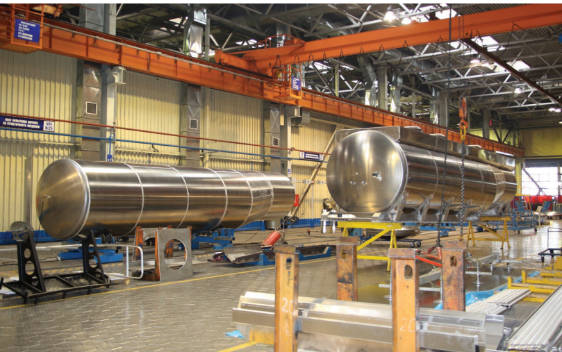
Производственный процесс изготовления цистерны
