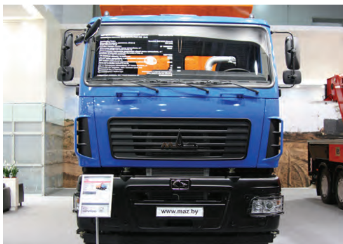
Автомобиль-самосвал МАЗ-6516Y9 с колесной формулой 8х4 с задней разгрузкой предназначен для перевозки различных сыпучих грузов
