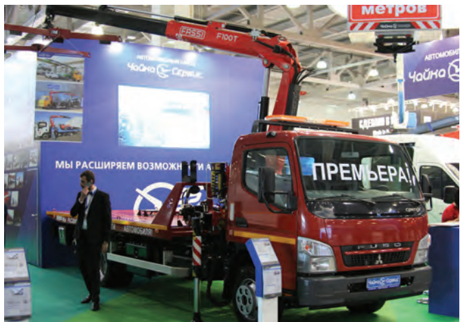
Эвакуатор FUSO FE 85DJ со сдвижной платформой с краном
