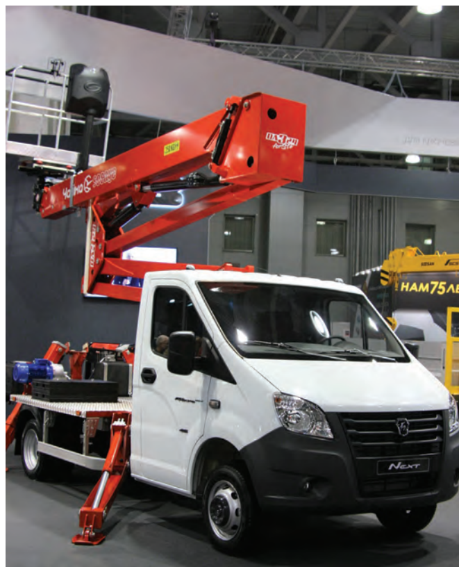
Автомобиль «ГАЗель NEXT 4,6» с краново-манипуляторной установкой совмещает в себе функции автокрана и обычного грузовика
