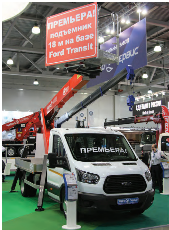
Автогидроподъемник на шасси Ford Transit оборудован телескопической автовышкой Чайка-Socage T318
