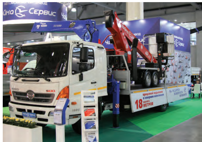
На базе шасси HINO-500 установлен тросовой кран КМУ Чайка-Tadano TM-ZE554HS
