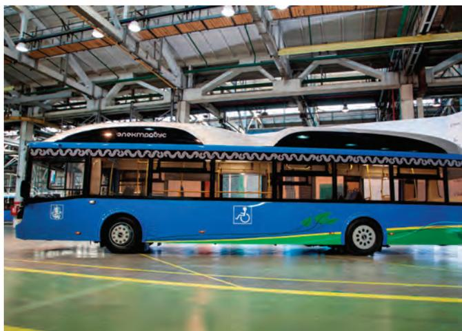
Электробус ГАЗ разработан на базе низкопольного автобуса большого класса ЛиАЗ-5292
