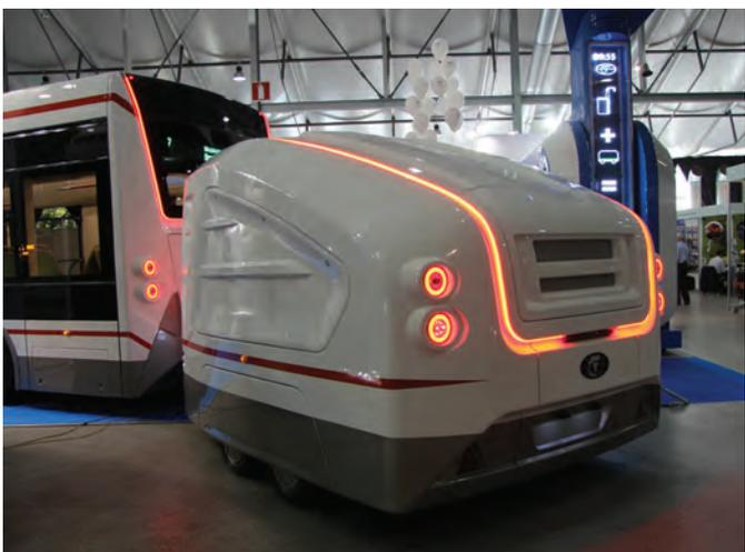
**Мобильная аккумуляторная установка размещается в специальном прицепе**
