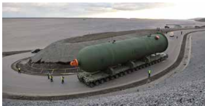
Транспортировка реактора для нефтеперерабатывающего завода весом 600 т
