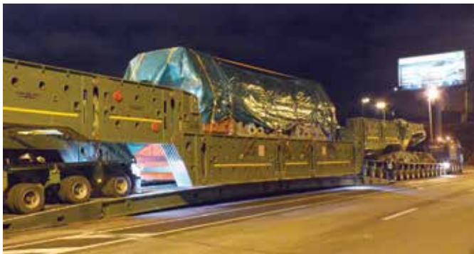
Транспортировка статора электростанции с полной массой автопоезда 800 т
