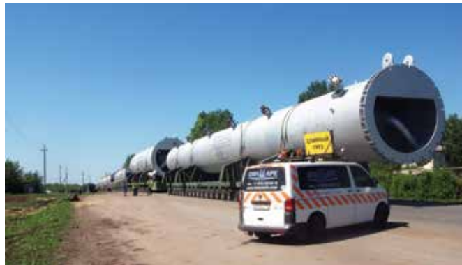
Одновременная перевозка партии груза, состоящей из четырех мест массой до 700 т каждое, с использованием самоходных и несамоходных модульных прицепов, общая численность осей которых превысила 100 единиц
