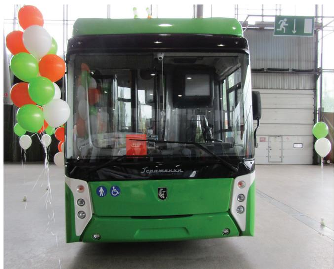
Троллейбус «Горожанин» с автономным ходом изготовлен на базе кузова автобуса «НЕФАЗ»
