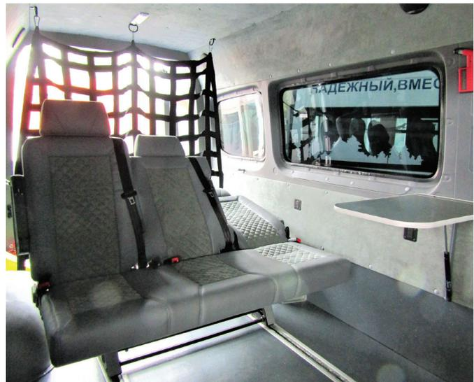
Комфорт пассажиров обеспечивают 2 дивана «Тандем» с возможностью полного раскладывания в спальное место
