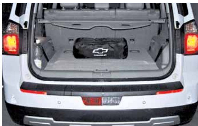
Третий ряд сидений в сложенном варианте образует багажное пространство объемом 454 литра
