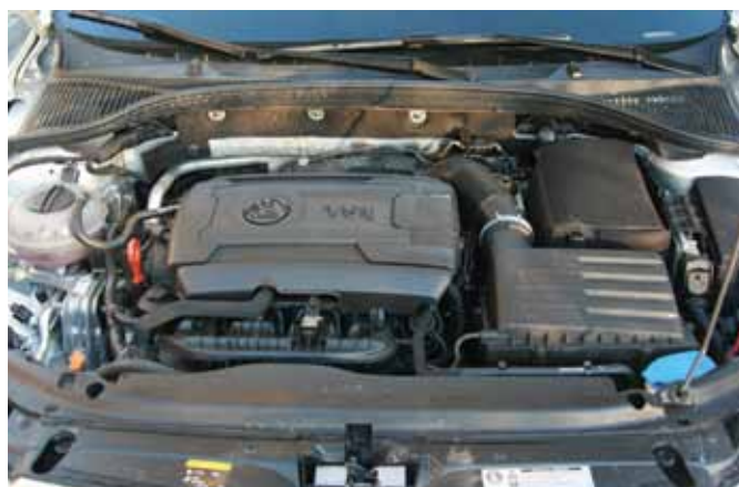
Силовой агрегат 1.8 TSI выдает 180 л.с. и разгоняет Skoda Octavia до сотни за 7,3 секунды
