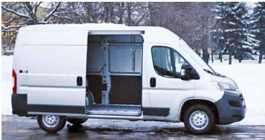
Сдвижная боковая дверь размером 1250x1755 мм обеспечивает удобный доступ в грузовой отсек и легкую погрузку европалеты
