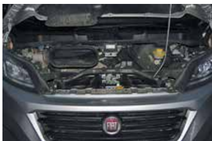
Модернизированный дизельный турбодвигатель MultiJet II объемом 2,3 л выдает 130 л.с. при 3600 об/мин
