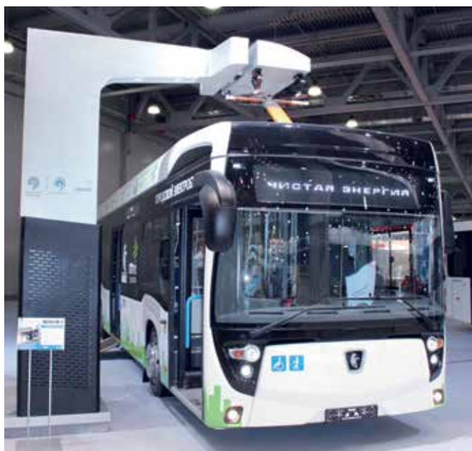
Электробус КАМАЗ-6282 заряжается от станций ультрабыстрой зарядки с помощью полупантографа, в дополнение используется бортовое зарядное устройство, позволяющее заряжать накопитель от трехфазной сети переменного тока 380 В («ночная зарядка»)
