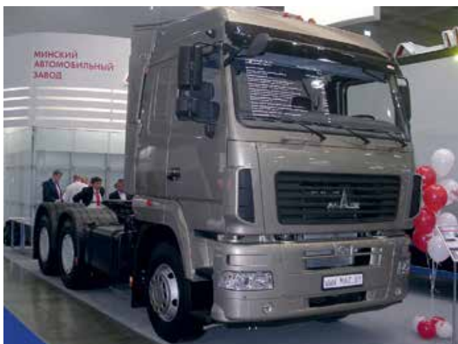
Седельный тягач МАЗ-643029-1420-012 с колесной формулой 6x4
