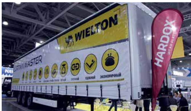
Шторно-бортовой полуприцеп Wielton NS 3 S KB приспособлен для перевозки рулонных грузов: для этих целей предусмотрен наклонный желоб
