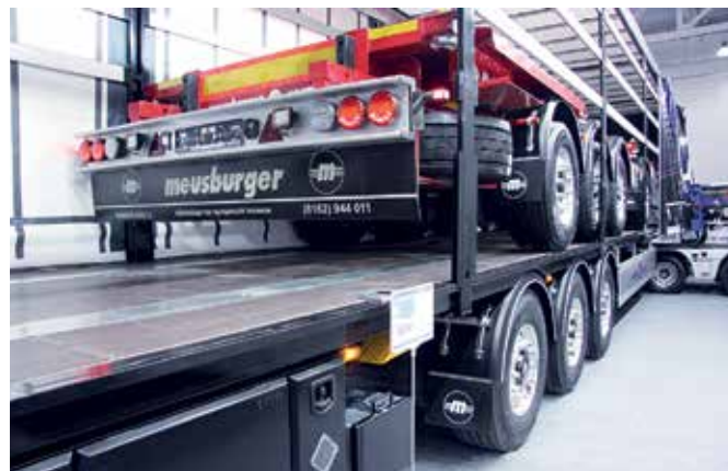
Контейнеровоз Meusburger Новтрак SW-454 (в верхней части фото) допускает перевозку одного или двух 20-футовых контейнеров, одного 40-футового или 45-футового High Cube контейнера
