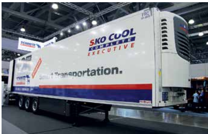
Рефрижераторный полуприцеп S.CO Cool с собственной холодильной установкой
