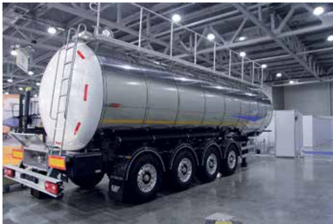
Четырехосный полуприцеп-цистерна ППЦ-877722 вместимостью 32 м 3 производства FoxTank – решение позволяющее повысить производительность, избегая перегрузов
