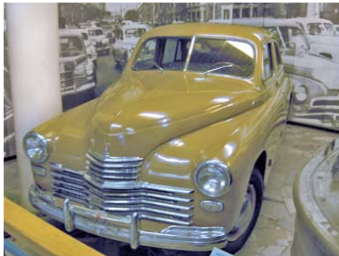
Легендарная «Победа» ГАЗ-М20 – первый автомобиль с несущим кузовом понтонной формы
