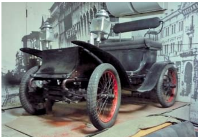
«Вюатюретка» De Dion Bouton с оригинальной конструкцией задней подвески, получившей название «Подвеска Де Дион»
